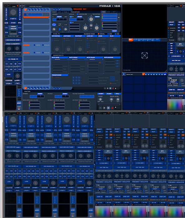
Ilustración 5: La imagen de arriba corresponde a la interface de Modul8, software que sirve de “puente” para las otras aplicaciones de video e imagen. Abajo se muestra la consola de comandos de Modul8. A través de esta se puede programar la secuencia y la conexión con los programas de audio o señal MIDI.
