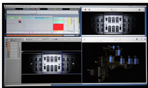
Ilustración 4: Interface del MapMapping. Software con el que se realiza tanto el mapeo de los objetos o fachada, como la proyección de videos (según la construcción de una grilla).
